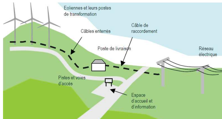
Figure 1 : Schéma descriptif d'un parc éolien terrestre (MEEDM 2010)
