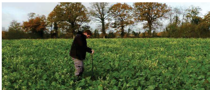
Photo 4 : Prélèvement à l'aide d'une tarière pédologique – Calidris
